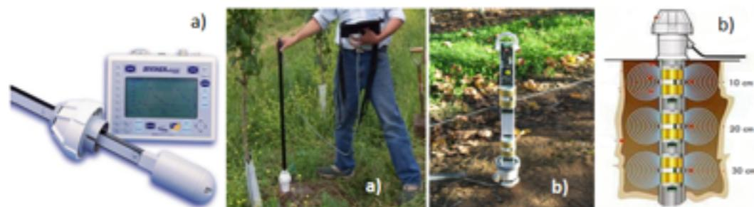
**Figura 37 – Sondas FDR com os respetivos tubos de acesso, sonda DIVINER (a) e sonda ENVIROSCAN (b).**
