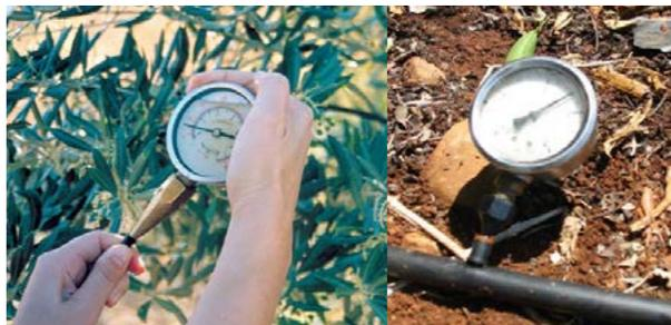
**Figura 29 – Aspeto da medida da pressão do escoamento com um manómetro, num tubo de inserção de um gotejador (Junta de Andalucía, 2010), e directamente num lateral de rega (COTR, 2009).**
