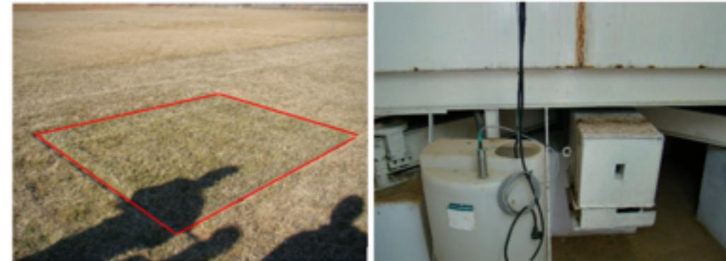
**Figura 7 – Aspecto de um lisímetro para avaliação da evapotranspiração de referência (ET<sub>o</sub>) revestido com relva (cultura de referência), e espaço subterrâneo com destaque para a balança de precisão.**
