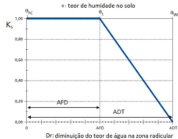
**Figura 12 – Variação do coeficiente Ks entre os teores de humidades correspondentes às constantes de humidade capacidade de campo (θ<sub>FC</sub>) e coeficiente de emurchecimento (θ<sub>WP</sub>).**
