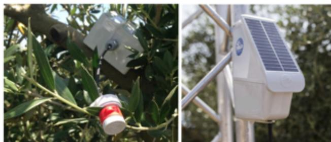
**Figura 47 – Sensor para detetar variações de turgescência das folhas de oliveiras, relacionadas com variações de potencial hídrico e aparelhos de processamento, armazenamento e transmissão dos dados (IRNAS, 2018).**
