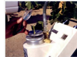
**Figura 36 – Câmara de pressão em utilização, destacando-se a observação com uma lupa da exsudação de água no pecíolo de uma folha.**
