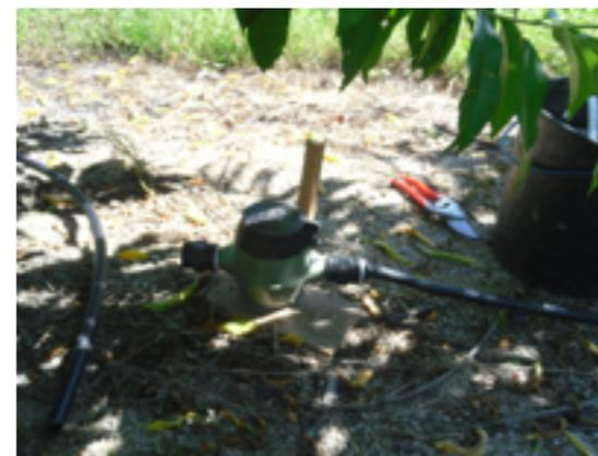
**Figura 26 – Medidor volumétrico de caudais instalado numa lateral de um sistema de rega gota-a-gota.**
