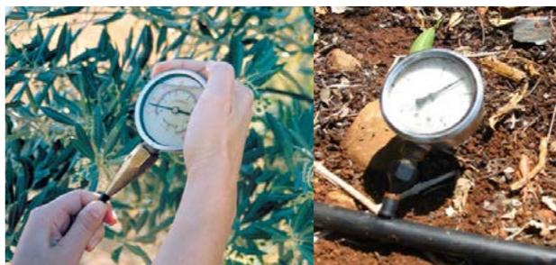
**Figura 32 – Aspecto da medida da pressão do escoamento com um manómetro, num tubo de inserção de um gotejador (Junta de Andalucía, 2010), e diretamente num lateral de rega (COTR, 2009).**
