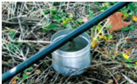
**Figura 31 – Aspeto da recolha de água num copo, para avaliação do caudal de um gotejador (COTR, s/d).**
