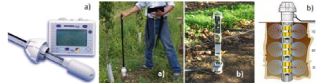
**Figura 40 – Sondas FDR com os respetivos tubos de acesso, sonda DIVINER (a) e sonda ENVIROSCAN (b) (Duarte, 2016)**
