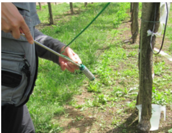
Figura 2.17 – Colocação de sonda do tipo bloco de gesso
