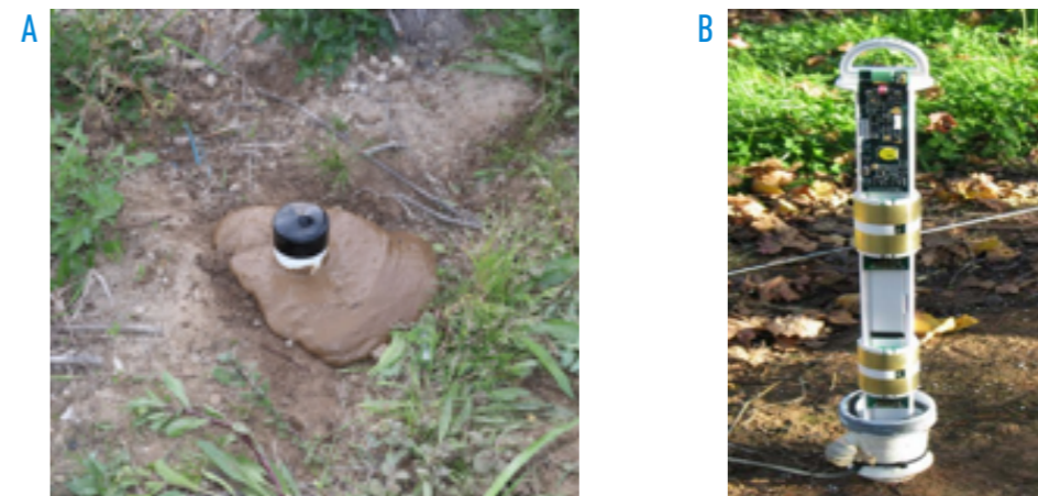
Figura 2.18 – Sondas capacitivas para registar teor de água no solo: a) portáteis (Tubo de acesso para sonda TDR, Diviner 2000); b) registo contínuo (fonte: Birendra, 2016).
