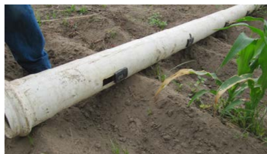
Figura 2.2 – Tubos com janelas utilizados para a rega de superfície no milho.
